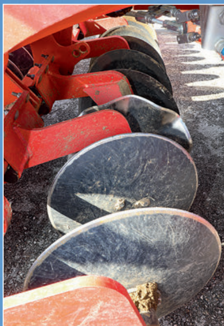
Sakarā ar disku X formas izkārtojumu paliek neapstrādāta josla, ar kuru tiek galā viļņotais disks.
