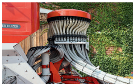
No 2022. gada pieejama opcija – sadalītāju daļēja vai pilnīga izslēgšana ar GPS vadību.
