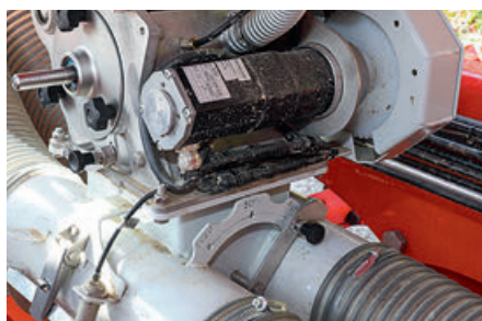
Slūžas ļauj individuāli iestatīt dozēšanu vienam vai abiem sadalītājiem.
