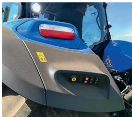
Aizmugurē līdzās uzkaarei un izvadiem tagad var aktivēt divu apgriezienu skaita iestatījumu saglabāšanu.
