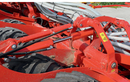
Līdztekus lemesīšu spiedienam tagad tiek hidrauliski regulēts arī sēklas iestrādes dziļums.
