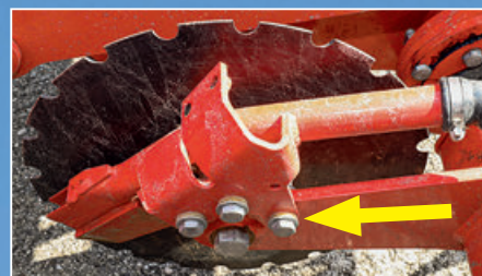
Gumijas starplikas pielāgo spēku, ar kādu mēslošanas disks piespiežas pie lemesīša.
