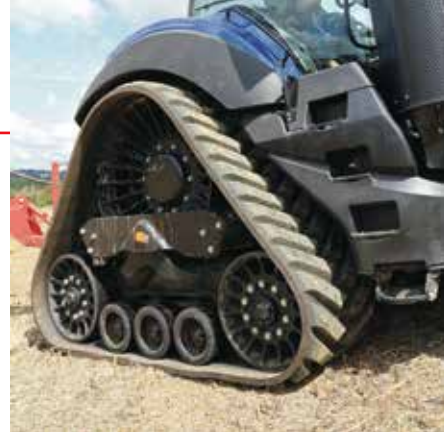
Kāpurķēžu traktoriem ir jauni veltni un jauna ķēdes opcija no Camso, kas esot izturīgāka ceļa darbos.
