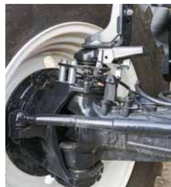
Priekšējā tilta balstiekārta ir pamatīgi pārstrādāta. Stūrēšanas leņķa sensors tagad piemontēts atbalsta šarnīra galā, padarot vienkāršāku piekļūvi.
