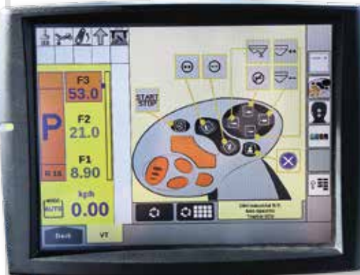
Tagad ir daudz vienkāršāk piešķirt dažādas funkcijas dažādām pogām uz galvenās vadības sviras.
