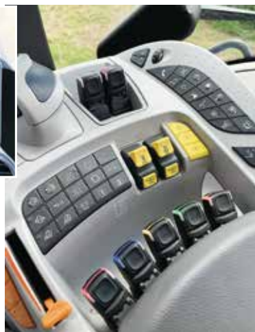
Izvadu slēdžiem mainās piešķirtā savienotāja krāsa.
