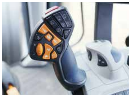
Tāpat kā iepriekš dzinēja un transmisijas vadības ierīces ir oranžas. Iespējams vēl daudz vairāk pielāgot hidrauliskās funkcijas.
