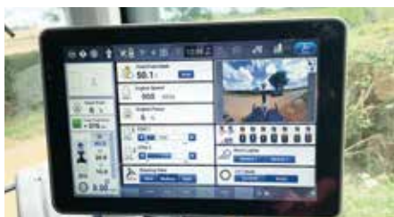
Priekšējā režģī uzstādītā kamera ir ļoti noderīga, lai izbrauktu uz ceļa. Attēls tiek parādīts galvenajā displejā, bet otra kamera vērsta uz traktora aizmuguri.
