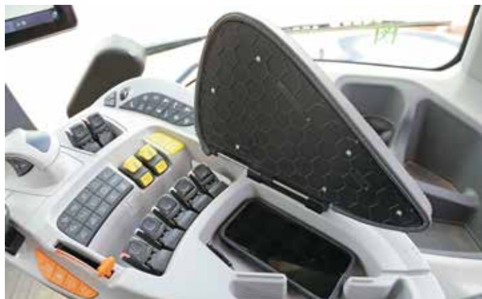
Paceļamo paneli virs elkoņu balsta kabatiņas var pārbīdīt uz priekšu, lai tas nosegtu visus izvadu slēdžus – vienkāršs un efektīvs risinājums.
