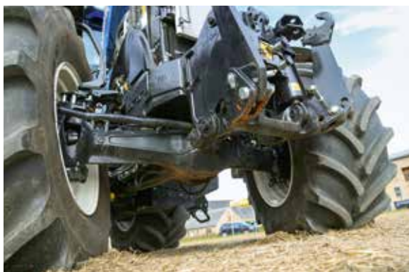
Priekšējā tilta balstiekārta ir pamatīgi pārstrādāta. Stūrēšanas leņķa sensors tagad piemontēts atbalsta šarnīra galā, padarot vienkāršāku piekļūvi.
