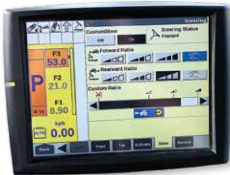
CustomSteer funkcija tiek ieslēgta un iestatīta no termināļa.
